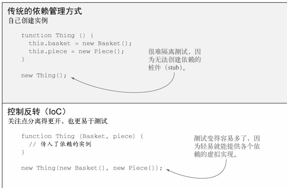
图5-3 IoC比传统的依赖管理方式提升了可测试性
